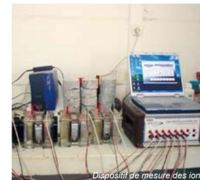
Dispositif de mesure des ions.
